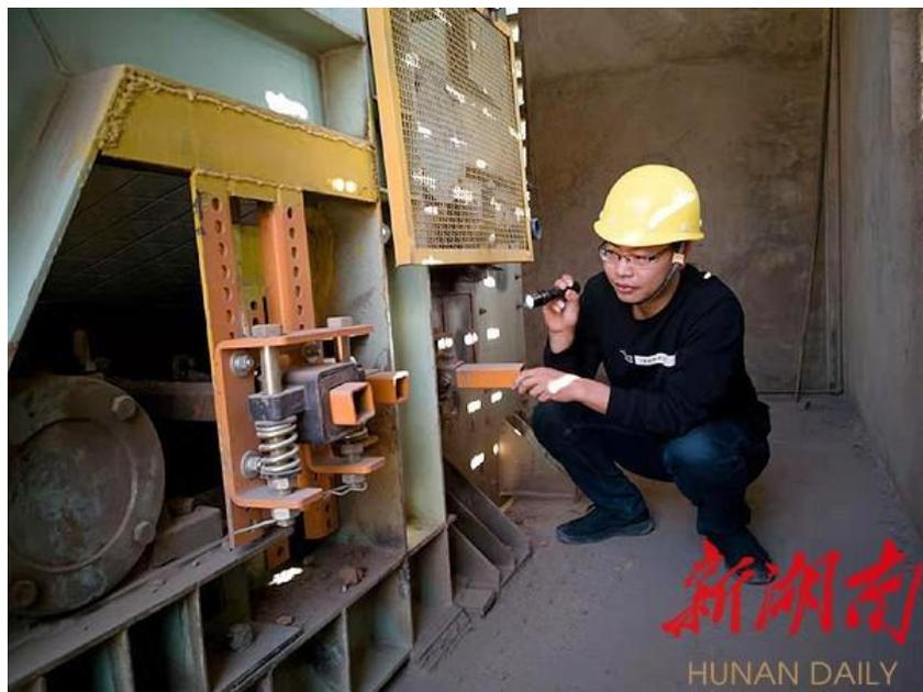
图 谢志勇在湖南江华海螺水泥厂检查皮带机清扫器
