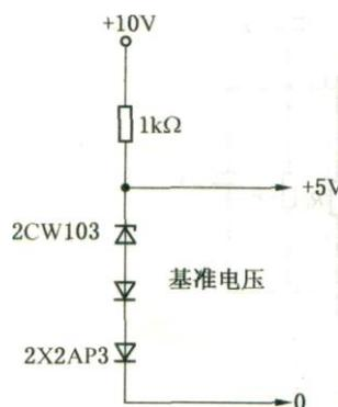
图 1-17 串联二极管调整基准电压
