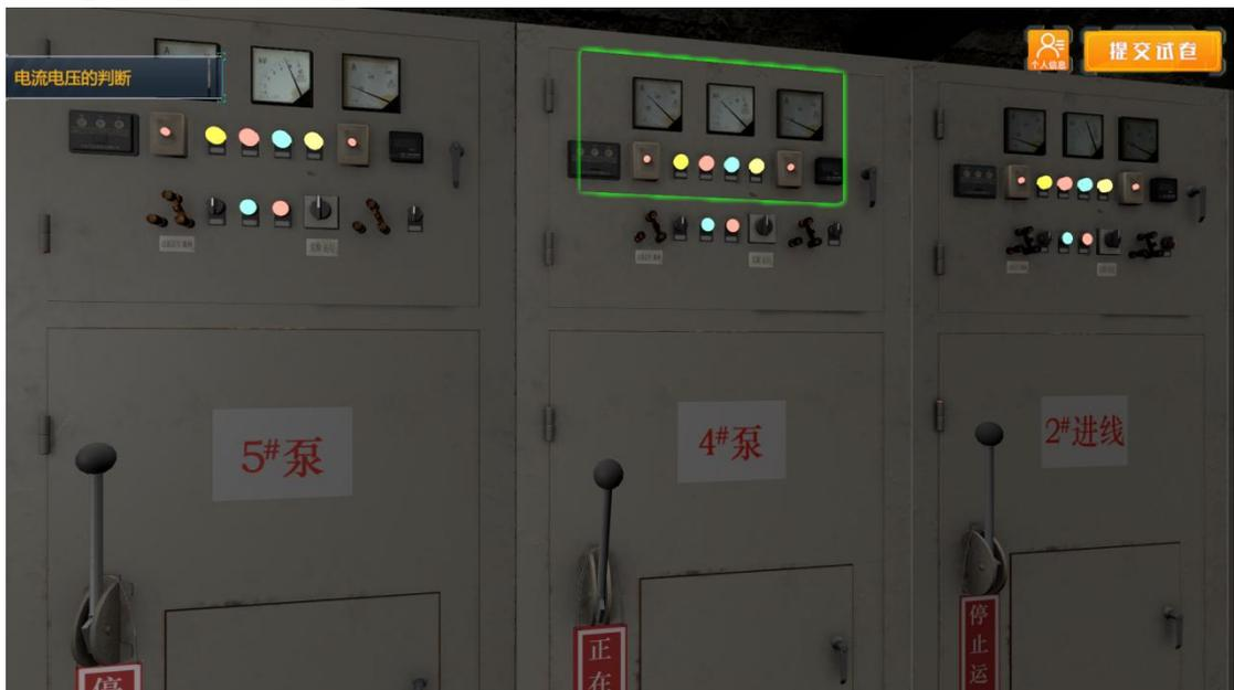
点击电压表进行判断，发现波动超过 5%，存在异常，异常原因是泵体平衡环磨损
