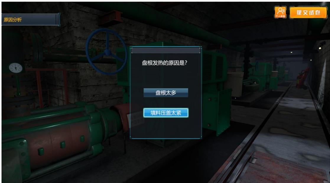
停车检查—首先关闭水泵的调节阀
