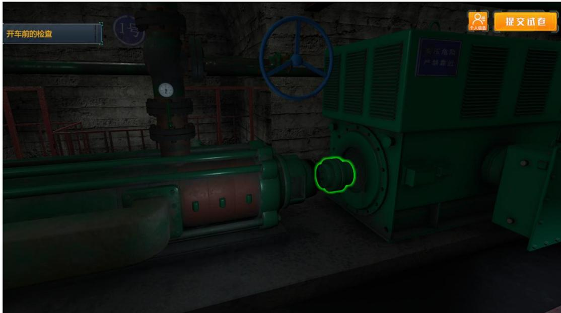
PS: 正确的联轴器间隙 2mm-5mm, 由于间隙大小是随机, 请正确选择
