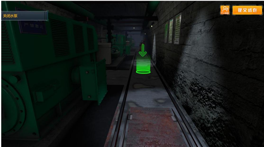
然后点击操作箱进行操作（PS：记得要在电流降至 1/3 的时候再点击关闭按钮）
