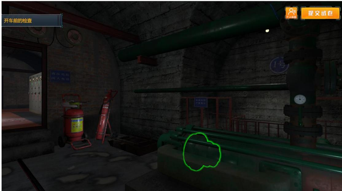
根据水泵的盘根是否滴水来判断盘根的松紧程度，不滴水说明盘根过紧，松紧度不合适。滴水说明松紧度合适，请正确选择
