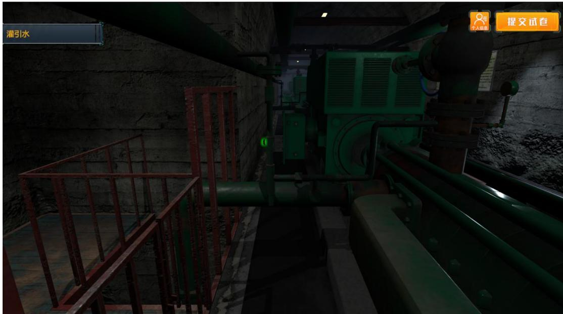
3.点击排空气阀关闭它（PS：记得等水管有恒定的水流出后，再关闭排空气阀）
