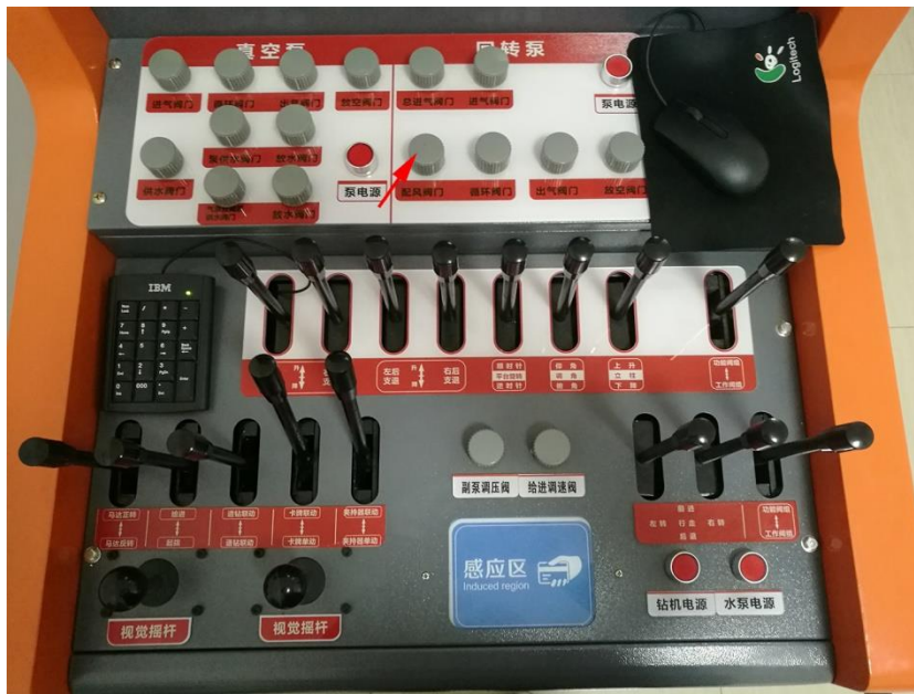
关闭操作面板上的“配风阀门”（顺时针旋转）
