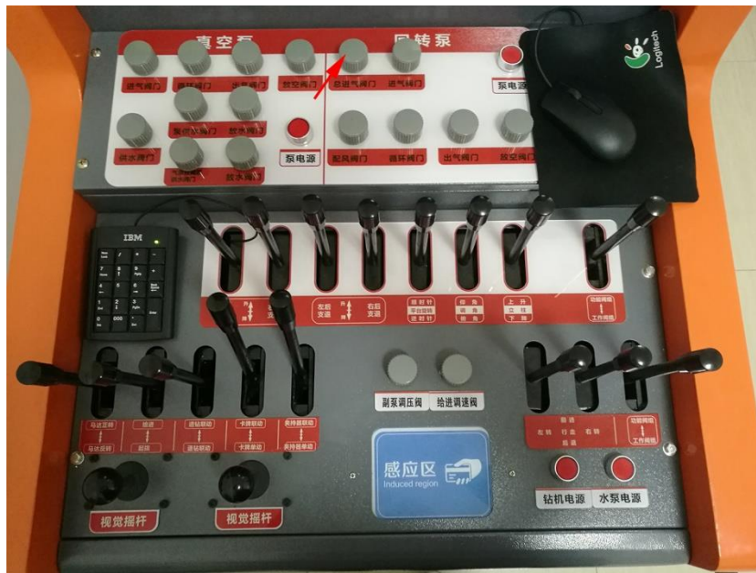
打开操作面板上的“总进气阀门”（逆时针旋转）
