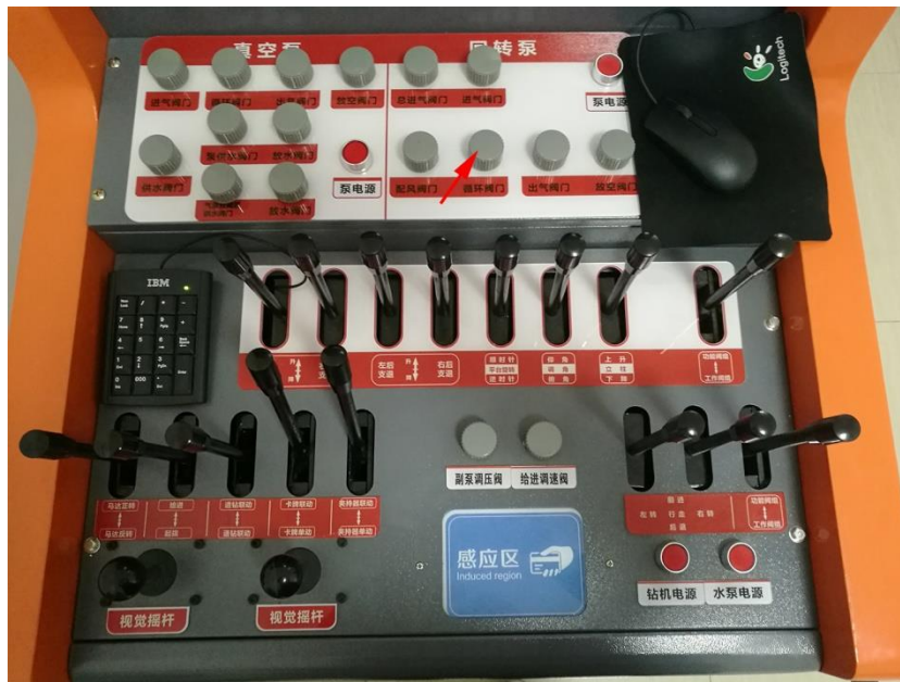
关闭操作面板上的“循环阀门”（顺时针旋转）
