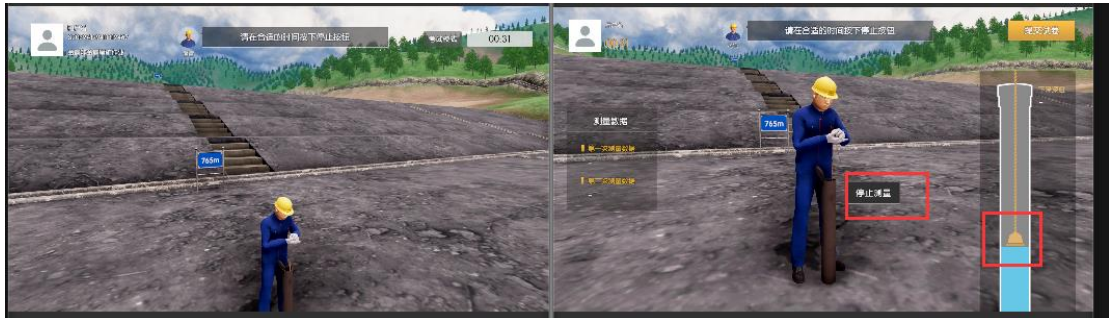
2) 在听见测深钟落水音效时，或者测声钟接触水面，并没有完全进入水时按下停止按钮为正确，在接触水面的时候速度会变慢方便操作。考点：第一次测量
