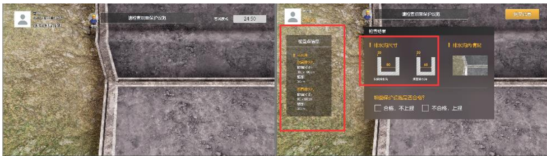
2) 点击检查点图标，进入看细节情况，先根据设计参数与实际尺寸判断是否正常，在看排水沟内情况看有没有淤堵物。然后做出判断“合格，不上报”或者“不合格上报”。 考点：坝面保护设施隐患排查
